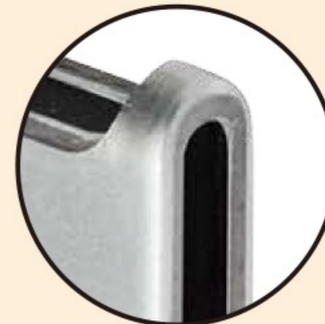
金物は二重構造。地震の揺れで筋かいが引っ張られると上下6力所のブリッジ部が粘り強く受け止めて倒壊を防ぎ、筋かいの損傷も抑えます。
